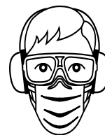
Bilde 6. OBS! Ved kapping av blokker skal beskyttelsesbriller, hørselsvern og støvmaske brukes.
